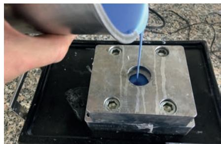
Плотно зафиксированная резьбовыми соединениями кювета заполняется супергипсом IV класса (Exakto-Rock S или Fluid-Rock). Приблизительно через 40 минут половинки кюветы можно разделить и выварить воск.
