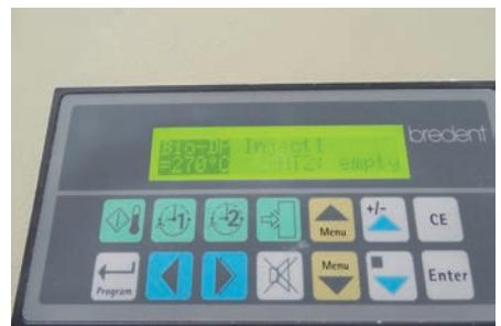
Алюминиевые картриджи смазать термопастой. Вставить картридж в нужную камеру. Выбрать программу Bio Dentaplast 2. Активировать процесс нагрева.
