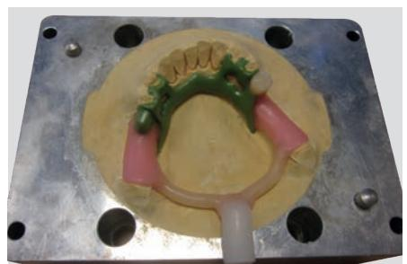
Помимо пленочного штифтования моделирование может быть выполнено с помощью двух подводящих каналов ( $\varnothing 5 \text{ mm}$ ).
