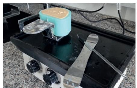
Заливка формы для дублирования силиконом Exaktosil N 21, затем заливка супергипсом Exako-Rock S.
