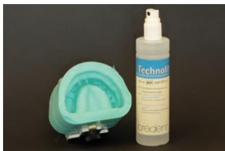
Снятие поверхностного натяжения дубликата с помощью Technolit.
